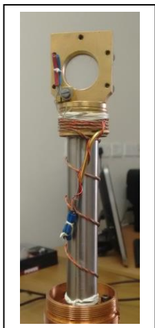
(d): Cryostat without radiation shield
